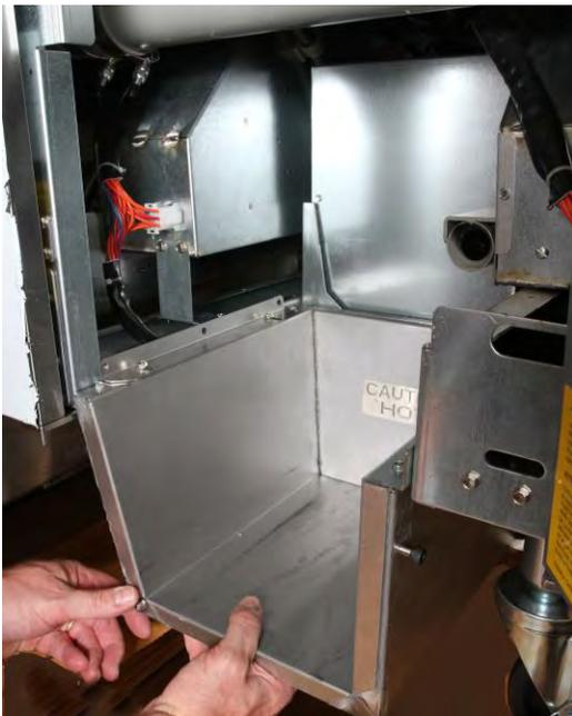
**Рис. 2.** Установите устройство для растапливания.
